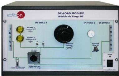
Si le commutateur "Meas" est placé en position "BEFORE", les capteurs de mesure de charges DC sont connectés directement aux sorties de l'éolienne, avant le régulateur de charge des batteries. Dans cette position, il n'y a pas au régulateur-chargeur des batteries (sauf lorsque le sélecteur de charge DC est en position 4, déviation), de sorte que les batteries ne sont pas en charge.
