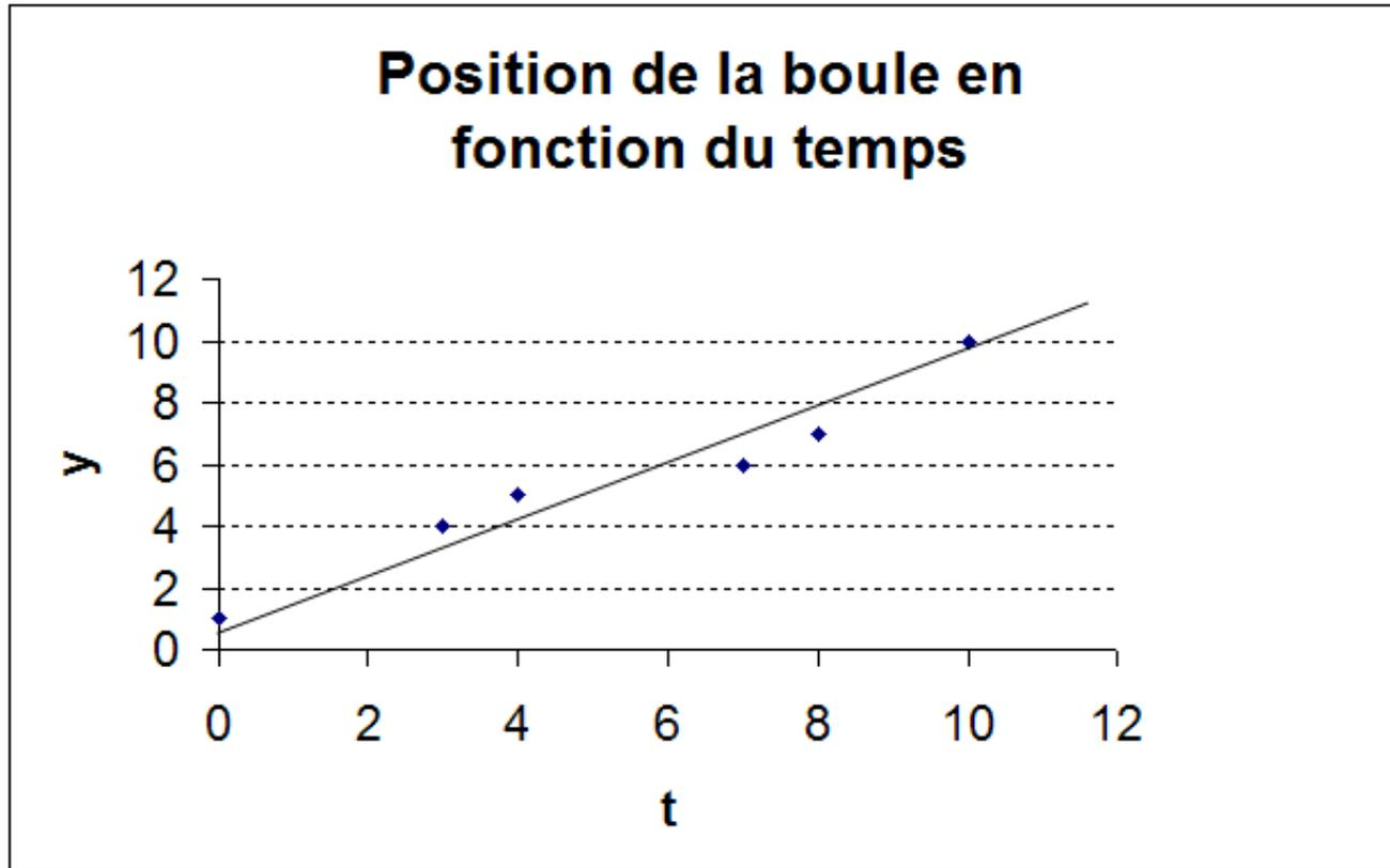
On constate que les points ne se trouvent pas sur une droite. On veut donc calculer  $a$  et  $v$  pour tracer la "meilleure" droite représentant les points mesurés
