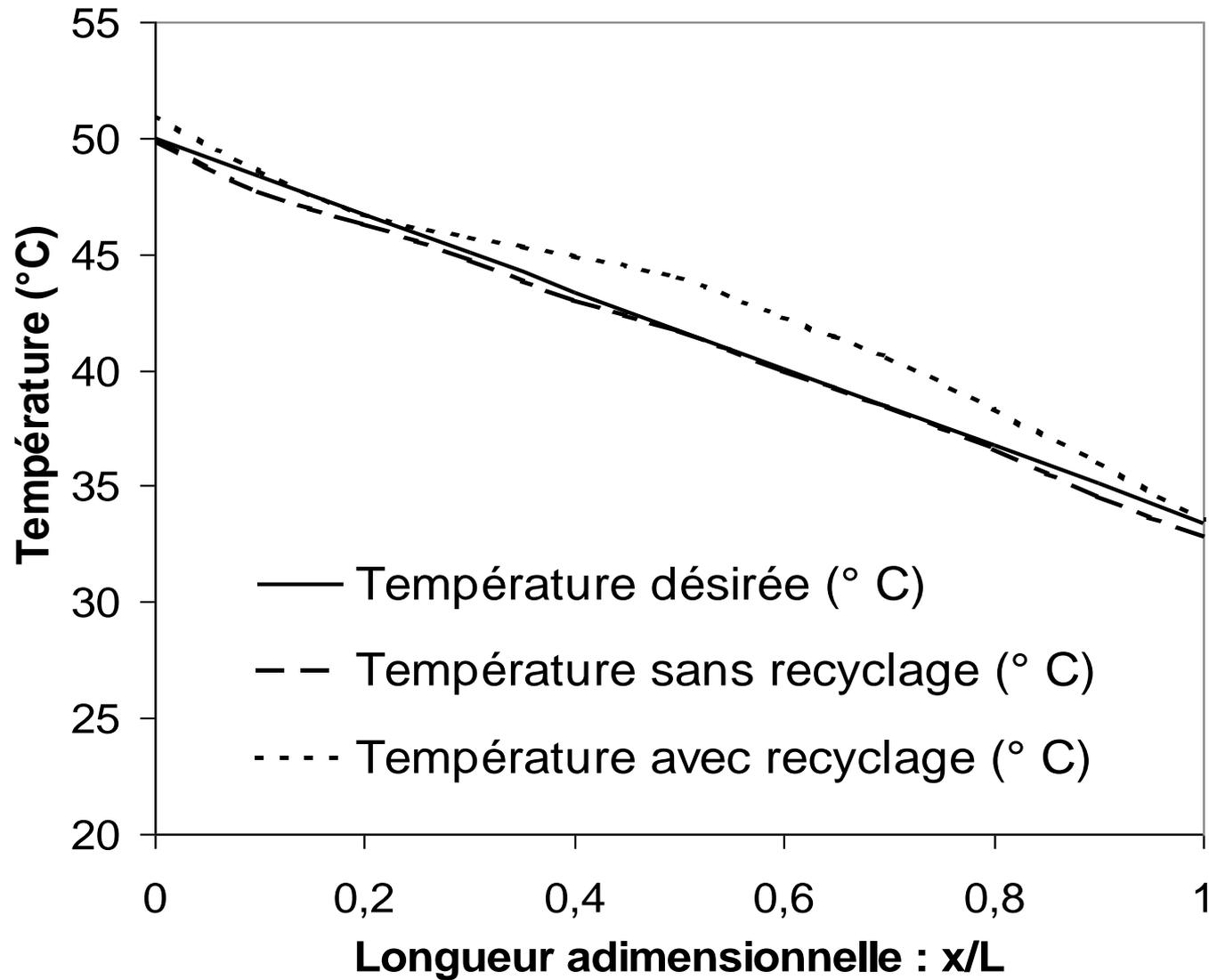
Figure 2 : Profil de température obtenu à la fin de la charge.
