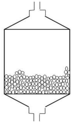
Ce modèle mathématique unidimensionnel tient compte de la différence de température entre l'air et le matériau de stockage
