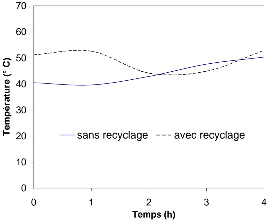
Figure 3 : Evolution de la température à l'entrée du stock au cours de la charge.
