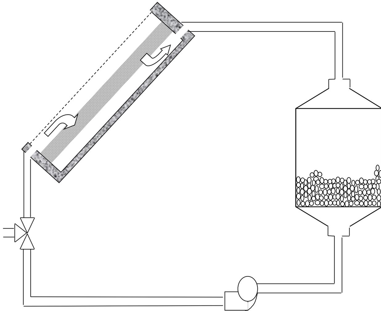
Figure 1 : *Installation solaire de production et de stockage de l'énergie.*
