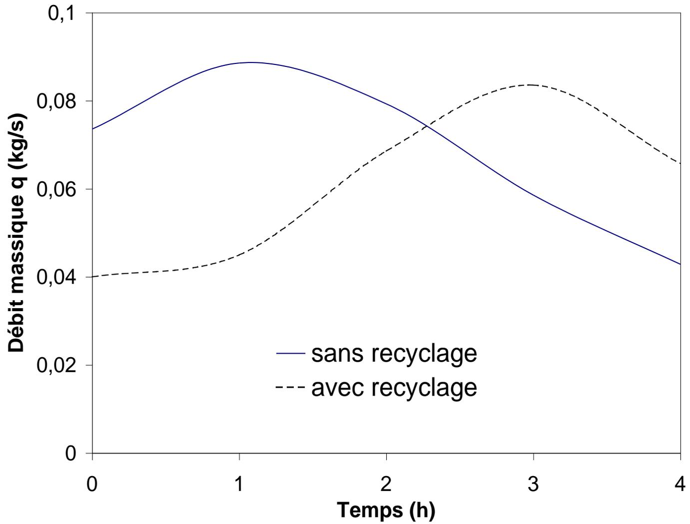
Figure 4 : Evolution de la commande (débit d'air) au cours de la charge.
