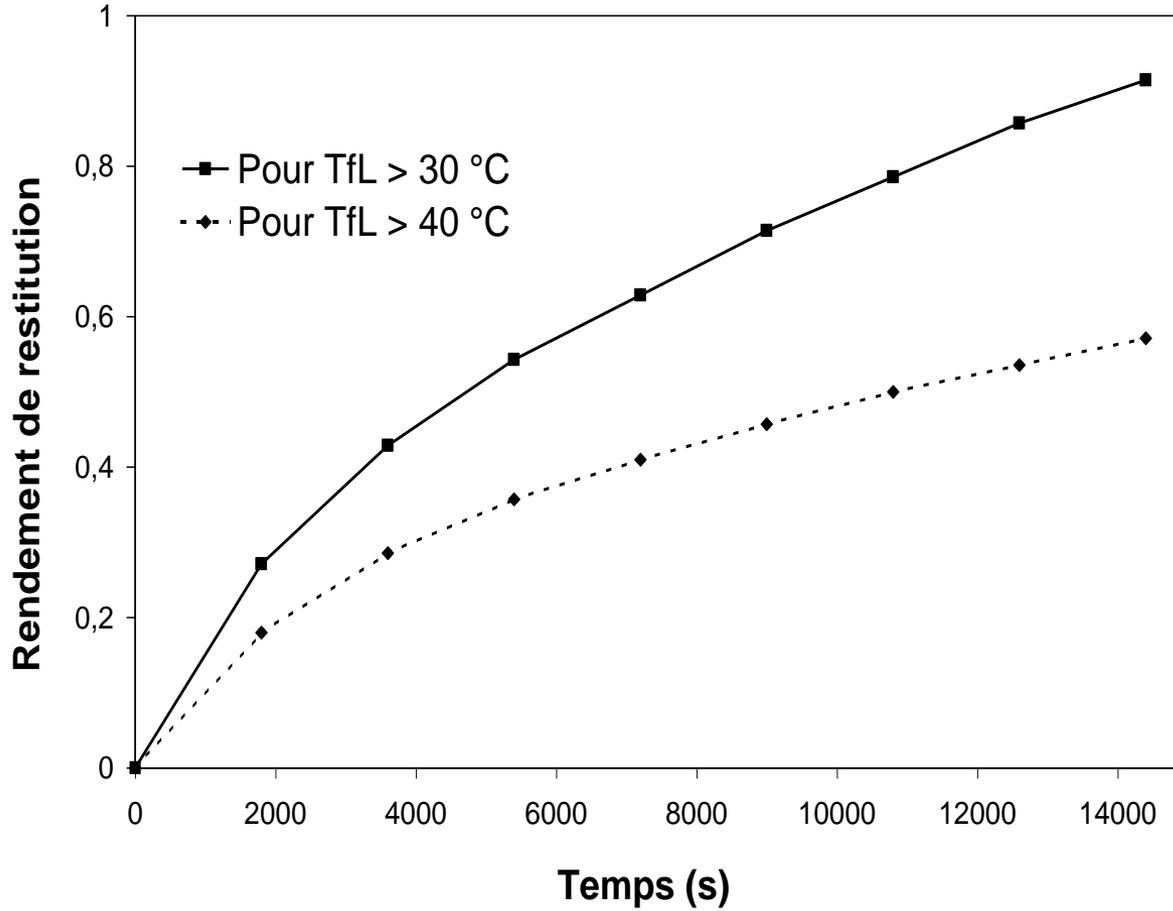
Figure 5 : Rendement de restitution de l'énergie stockée.
